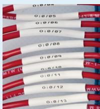
PermaSleeve Schrumpfschläuche zur Kabelkennzeichnung
